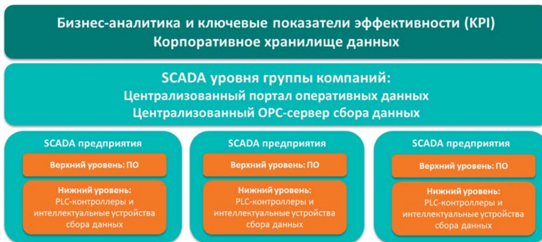
Принципиальная схема АСУЭ: уровни и основные подсистемы
