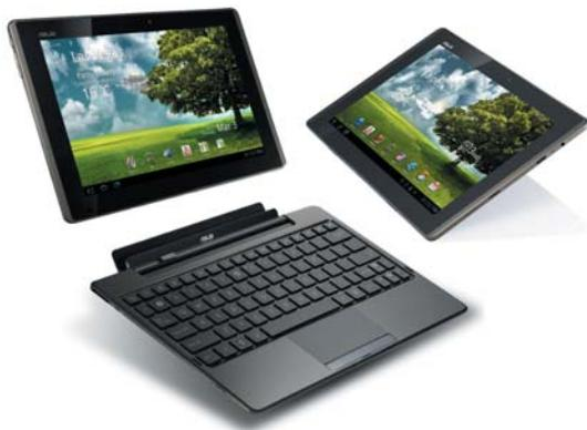
планшета представляет собой шарнир, позволяющий поворачивать экран совсем как у ноутбука, вплоть до полного складывания, пригодного для транспортировки. При этом общий вес устройства остается весьма комфортным: лишь немногим больше 1100 граммов!
