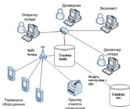
Рис. 1. Принципиальная схема работы WMS-системы
